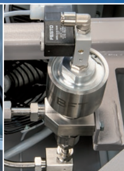
Das Druckentlastungsventil kann zur Vorgabe des Anschlussdruckes auch extern angesteuert werden.
